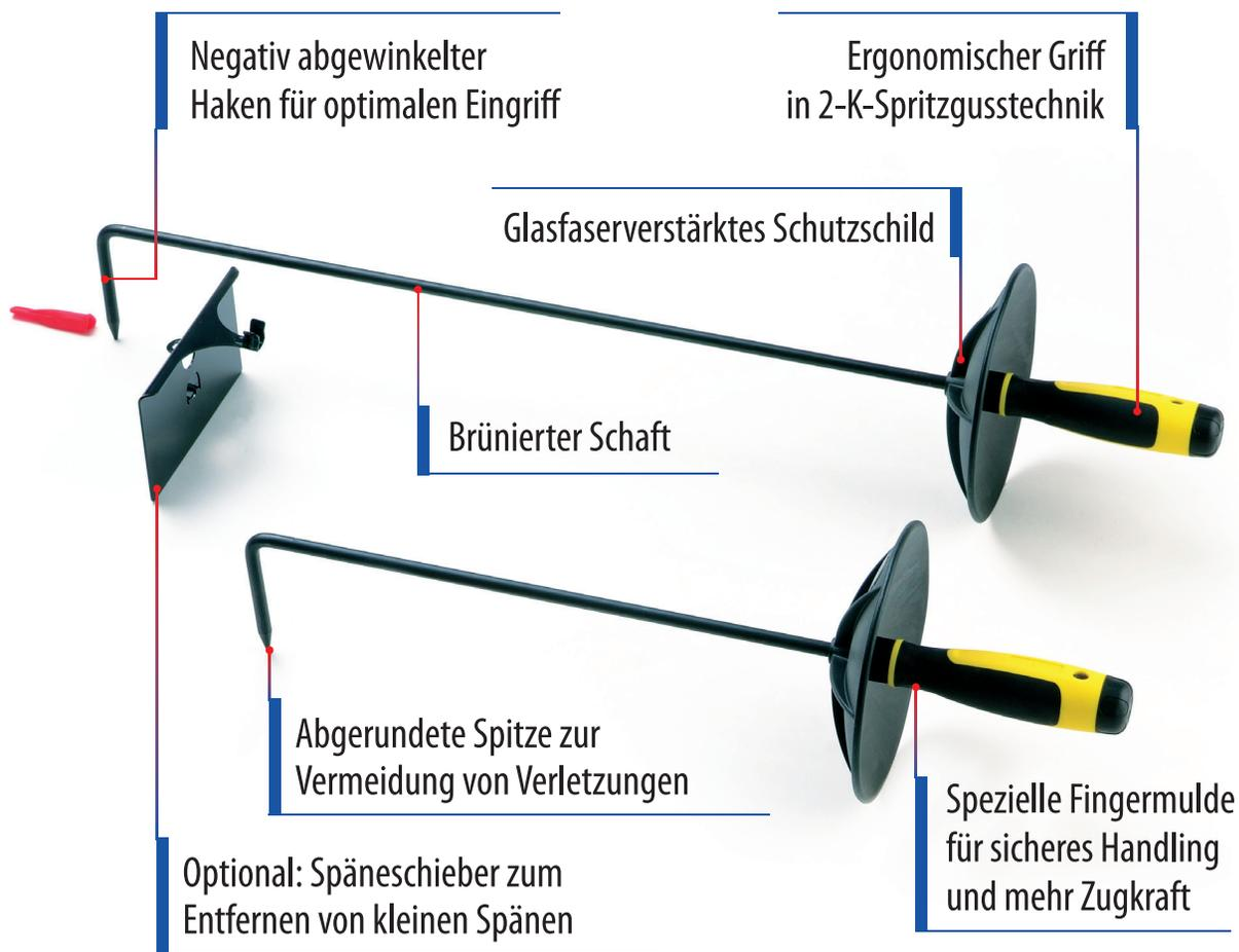
Der neue Spänehenken HOOKY mit seinem ergonomischen 2-Komponentengriff stellt in puncto Handling alles in den Schatten, was derzeit auf dem Markt verfügbar ist. Mit seinem glasfaserverstärkten Späneschutzschild entspricht er den höchsten Sicherheitsstandards und gewährleistet eine hohe Lang-lebigkeit. Die hochwertige Ausstattung orientiert sich nicht zuletzt an den berufsgenossenschaftlichen Vorgaben zur Vermeidung des Verletzungsrisikos.
