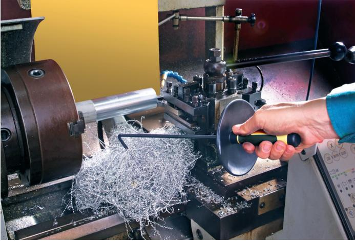
Zum Entfernen langer Schlingspäne und z.B. Kunststoffresten aus Spritzgussmaschinen. Der stabile Haken besitzt eine „stumpfe“ Spitze, welche eine Verletzungsgefahr vermindert.
