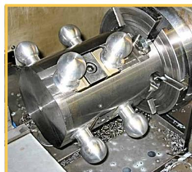
Zum Bearbeiten des Doppelkeilspanners, benötigen Sie eine Verriegelungsplatte. Diese ist dabei oder kann separat bestellt werden. Sie hält die Backen während des Formfräsens positionsstabil und vibrationsfrei.
