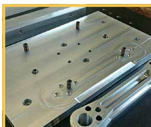
Unsere Pass- und Zentrierbolzen sind aus gehärtetem Einsatzstahl und äußerst präzise geschliffen. Die Keil- und Schwertformen gewährleisten genaues Zentrieren. Um möglichst einfache Elemente zu haben, werden alle Stifte mit M4 Innensechskant-Schrauben montiert. Dies erlaubt eine schnelle Entfernung, wenn die Stifte nicht benötigt oder ausgetauscht werden. Wenn man alle Vorrichtungen, Aufspannwürfel, Aufbauplatten usw. mit den gleichen Normteilen ausrüstet, verringert das die Rüstzeit.
